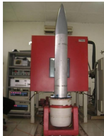
Gambar 3-6: Pengujian muatan roket di laboratorium
