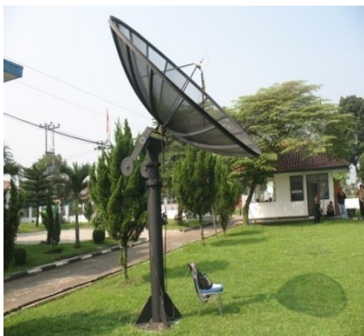
Gambar 4-5: Pengujian penerimaan sinyal satelit DFS
