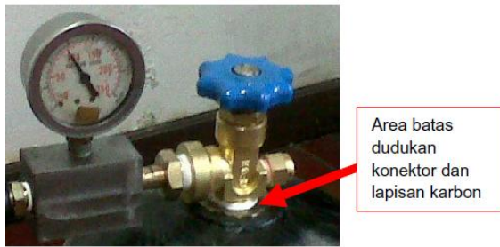
Gambar 3-8: Daerah rembesan pada pengujian tabung pertama saat tekanan 175 bar
