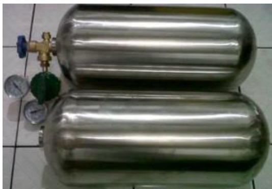
Gambar 3-5: Tabung liner stainless steel hasil rancang bangun sebelum dilapisi komposit
