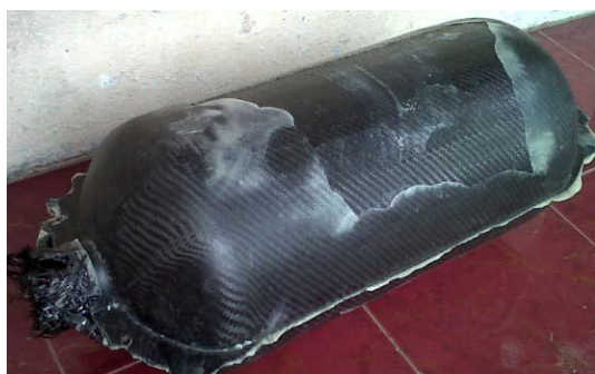
Gambar 3-6: Tabung yang dikeluarkan dari mattress setelah proses oven
