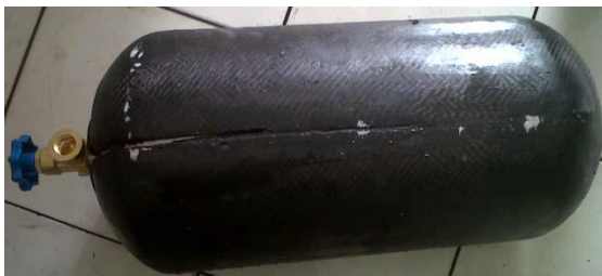
Gambar 3-9: Lapisan komposit karbon tabung pertama terbelah dua pada tekanan 200 bar
