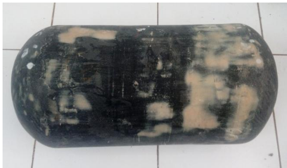
Gambar 3-10: Tabung komposit kedua setelah uji hidrostatis
