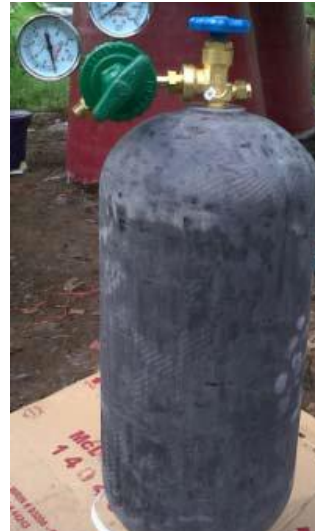
Gambar 3-7: Produk jadi tabung hybrid stainless steel - komposit karbon
