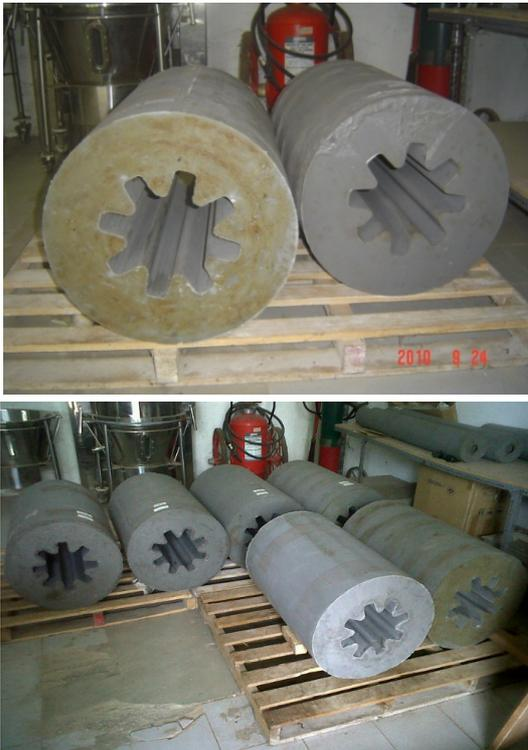
Gambar 3-8: Propelan untuk roket RX 550
