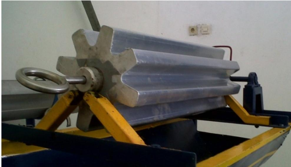
Gambar 3-5: Mandrell Pencetak Propelan RX 550
