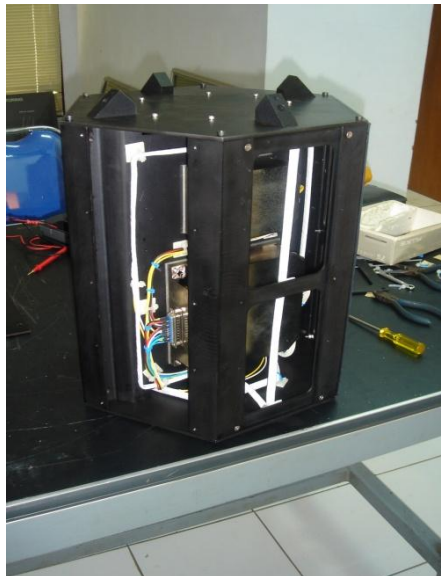
Gambar 3-3: Menunjukkan struktur Inasat-1 yang telah dirakit namun belum terpasang panel luarnya
