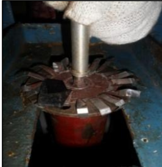
Gambar 3-7: Pencabutan mandril dari propelan
