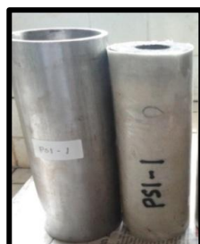
Gambar 3-9: (a) Propelan setelah diberi liner; (b) Motor roket siap di uji statik
