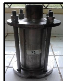
Gambar 3-9: (a) Propelan setelah diberi liner; (b) Motor roket siap di uji statik
