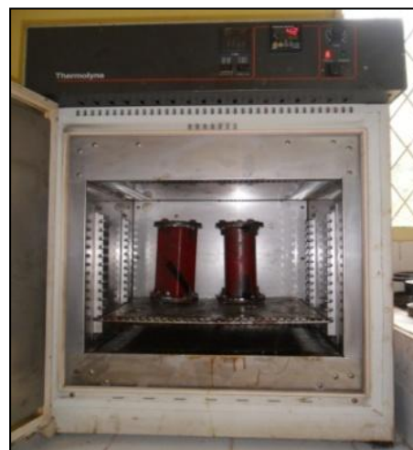
Gambar 3-6: Proses pematangan propelan dalam oven
