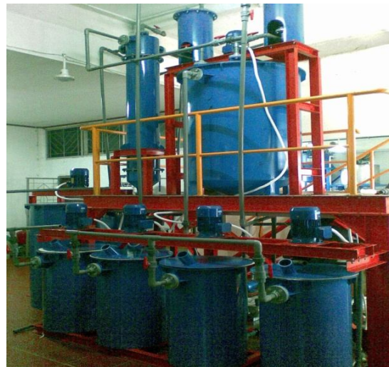
Gambar 4-1: Rangkaian alat pemurnian NaCl
