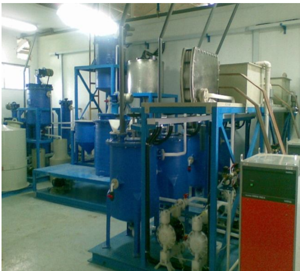
Gambar 3-1: Sel Elektrolisis \text{NaCl} menjadi \text{NaClO}_4
