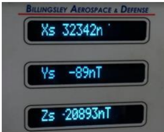
Gambar 5-3: Pembacaan sensor fluxgate magnetometer kalibrator komponen X,Y,Z terhadap intensitas medan magnet lingkungan (mode open loop )
