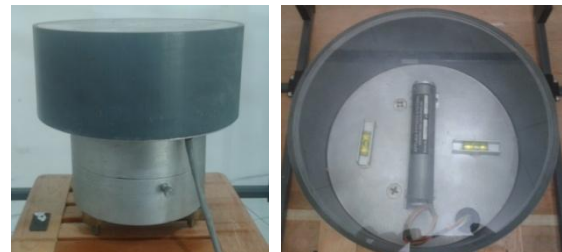
Gambar 2-2: Magnetometer digital tipe 1540 yang telah dilengkapi mounting sensor terbuat dari bahan non magnetik. Tampak samping (kiri) dan atas (kanan) (Sumber: LAPAN).
