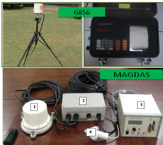
Gambar 1-2: Beberapa magnetometer yang digunakan untuk mengamati variasi harian geomagnet. Magnetometer MB162C, Magson, dan Magdas merupakan magnetometer tipe fluxgate , Lemi 030 merupakan tipe induction , dan G856 merupakan tipe proton (Sumber: LAPAN)
