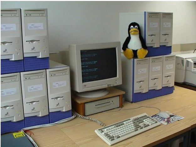
Gambar 3-1: Cluster komputer yang terdiri dari 10 komputer tunggal, dengan sistem operasi linux
