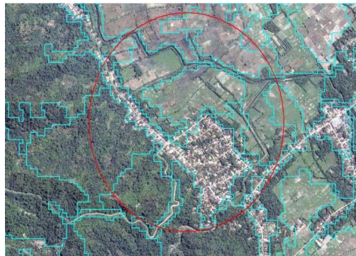
(a) Ploting hasil segmentasi skala 20, warna 0.9 dan kekompakkan 0.5 pada citra Quickbird pada lokasi 2
