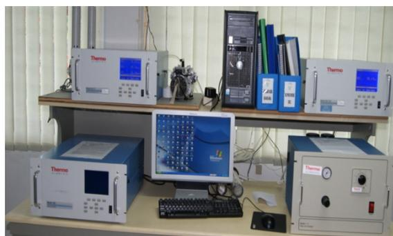
Gambar 3-2: NO-NO<sub>2</sub>-NO<sub>x</sub> Analyzer TS42iTL (kiri atas), SO<sub>2</sub> Analyzer TS43i-TLE (kanan atas), *Dynamic Gas Calibrator* TS146i (kiri bawah), dan *Zero Air Supply* TS111 (kanan bawah).
