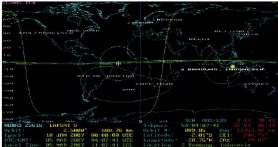
Gambar 3-7 : Prediksi lintasan LAPAN-TUBSAT 5
