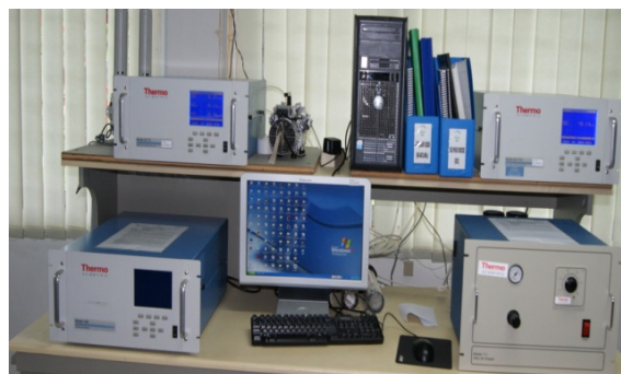
Gambar 3-2: NO-NO 2 -NO x Analyzer TS42iTL (kiri atas), SO 2 Analyzer TS43i-TLE (kanan atas), Dynamic Gas Calibrator TS146i (kiri bawah), dan Zero Air Supply TS111 (kanan bawah).
