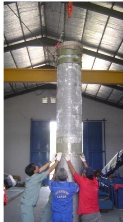
Gambar 3-2: Proses pengangkatan dan pemasukan propelan ke dalam tabung motor roket
