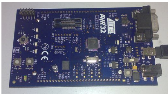
Gambar 3-2: Foto CPU yang sudah ter-integrasi dengan accelerometer LIS3LO6AL
