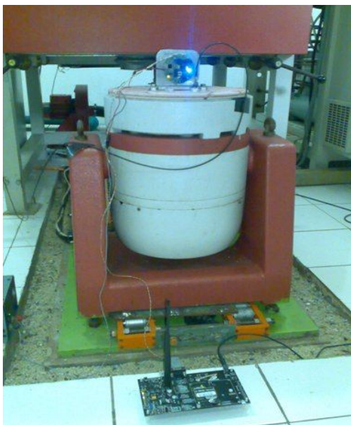
Gambar 4-3: Accelerometer dipasang pada vibrator dan dihubungkan dengan menggunakan radio modem
