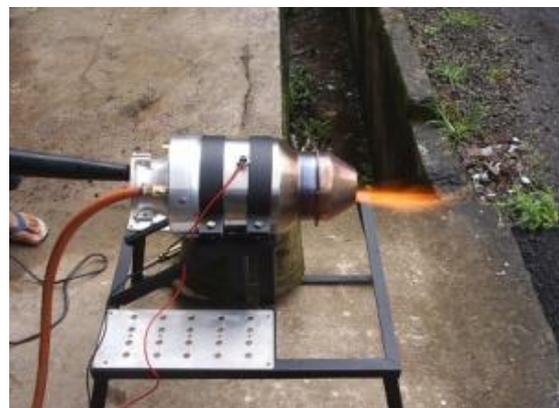
Gambar 1-2: Uji coba mesin turbojet TJE500FH v.1
