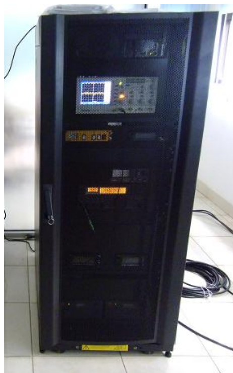
Gambar 3-1: Doppler receiver tracking roket untuk percobaan
