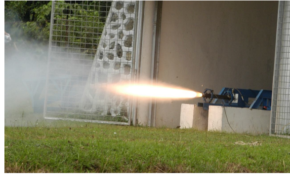
Gambar 4-1: Uji statik roket RX-70
