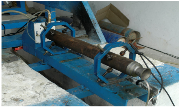
Gambar 4-1: Uji statik roket RX-70
