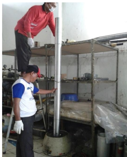
Gambar 3-4: Metode lining RX1220 dengan Shaker
