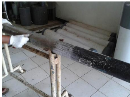
Gambar 3-7: Proses Perataan Lapisan Protektor Termal
