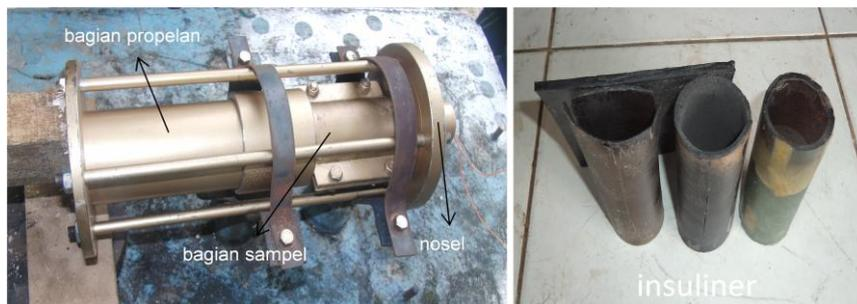
Gambar 3-1: Motor roket dan sampel *insuliner* hasil uji ablasi
