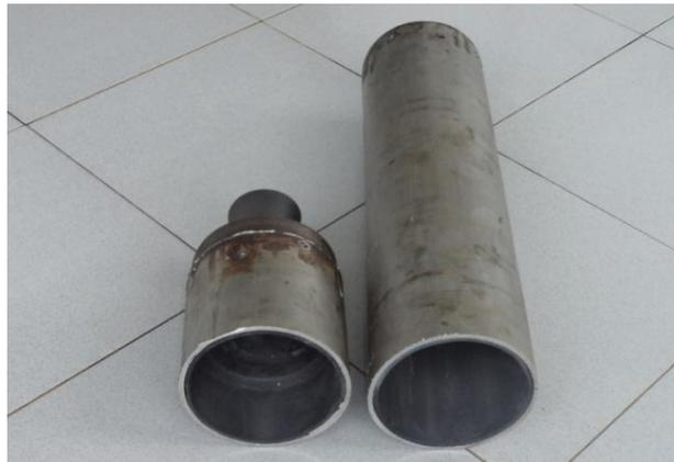
Gambar 4-2: Kondisi insuliner setelah pengujian motor roket case bonded
