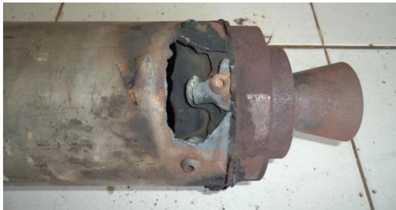
Gambar 4-3: Tabung motor roket lumer dan robek di bagian ujung
