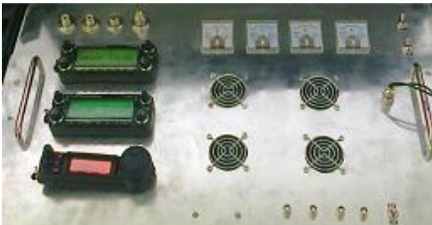
Gambar 3-2: Prototipe *Doppler transceiver* untuk uji kestabilan pengukuran frekuensi
