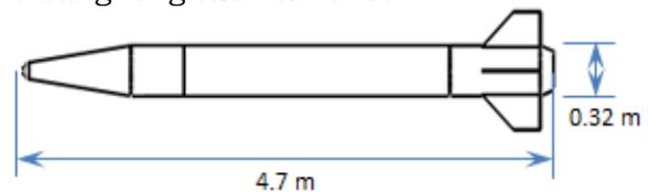
Gambar 4-1: Dimensi roket yang digunakan untuk simulasi di dalam penelitian ini
