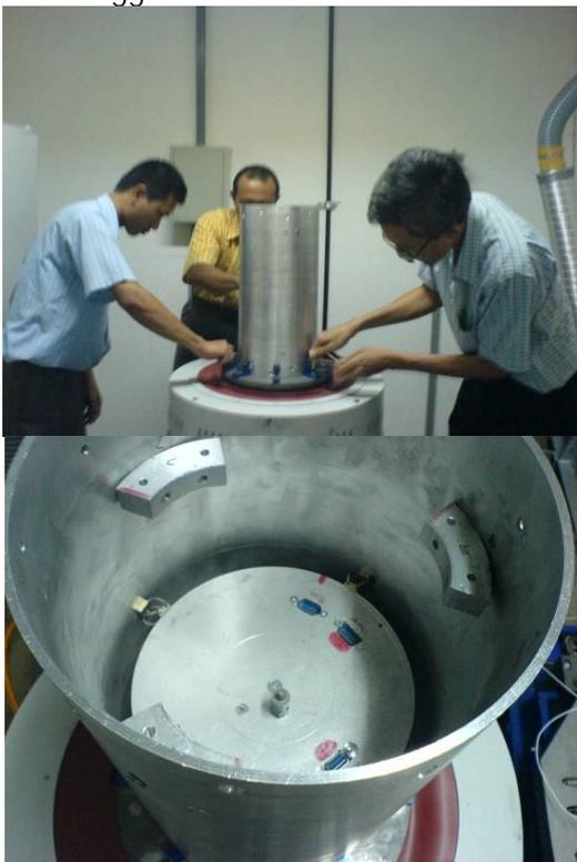
Gambar 3-1: Pemasangan mounting pada *actuator* vertical dan akselerometer pada *payload*
