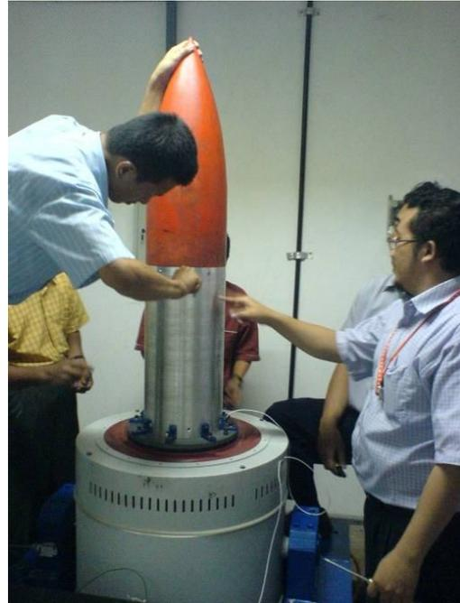
Gambar 3-5: Pemasangan *nose cone* yang berisi radio dan antenna agar data *payload* bisa dikirim
