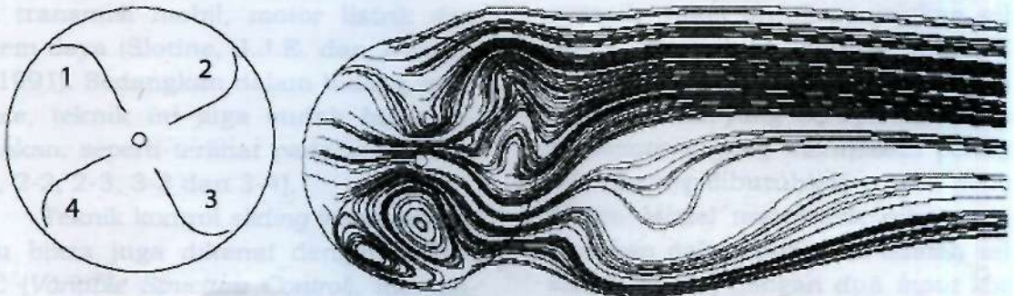
Gambar 4-4 : Visualisasi aliran Savonius sudu 4 pada V = 5 \text{ m/s} , \text{RPM} = 3
