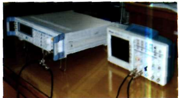
Gambar 4-2: Setup kalibrasi TDOA dengan RF sinyal generator dan digital osiloskop 2Gs/s
