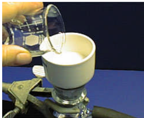
Gambar 3-8: Kertas saring dibasahi dengan pelarut
