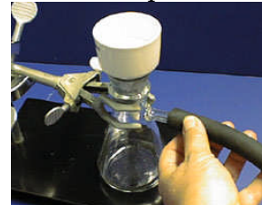
Hubungkan pipa labu ke sumber vakum dengan menggunakan selang yang tebal
