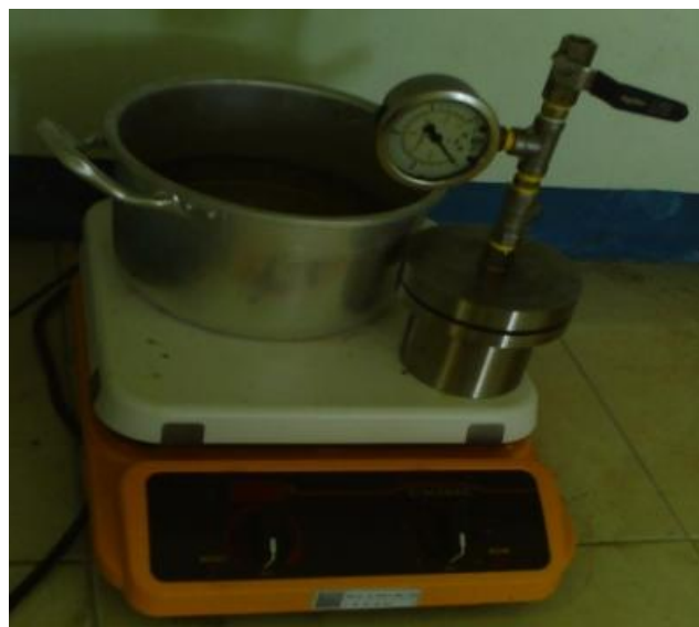
Gambar 3-1: Reaktor Autoklaf dengan Pemanas Hot Plate
