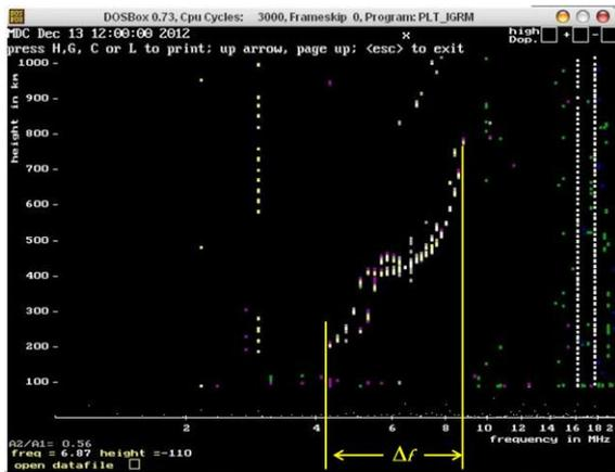
Gambar 3-2: Penentuan rentang frekuensi minimum-maksimum lapisan ionosfer
