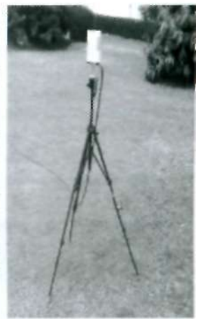
Gambar 4-1: Peralatan proton magnetometer 866 pada uji coba di SPD Tanjungsari
